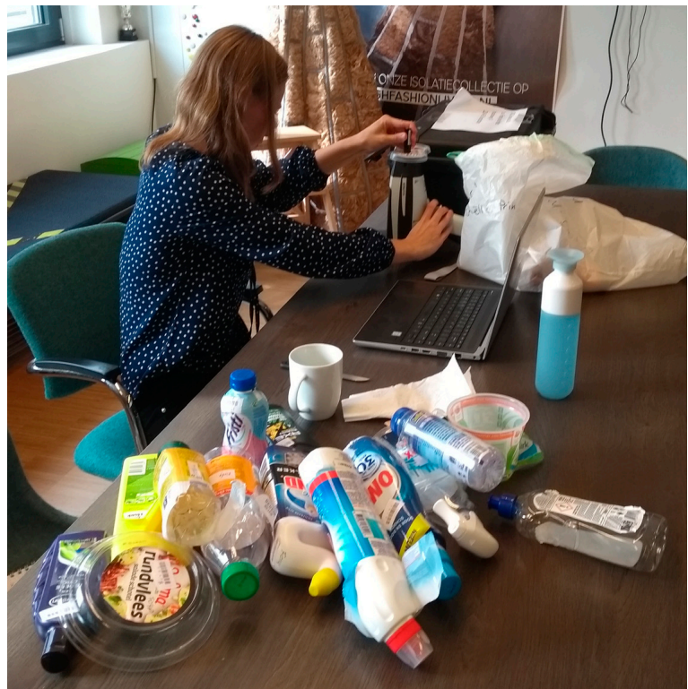
Bepalen van het type materiaal met een portable NIR-scanner
